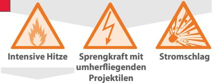
Schutzkleidung gegen Lichtbögen ist in erster Linie zum Schutz gegen die Hitze eines Lichtbogens und nicht gegen Stromschlag oder Sprengkraft ausgelegt.
